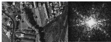
Рис. 3. Синтезированное по трем каналам панхроматическое изображение со сверхразрешением второго каскада и его ПЧС
