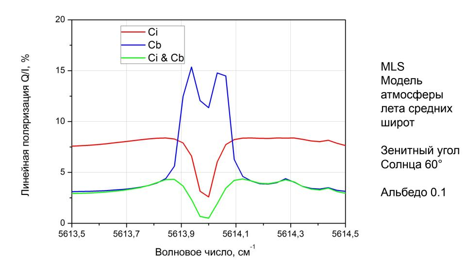
Линейная поляризация Q/I (%) уходящего солнечного излучения кучево-дождевыми (H=4-5 км, т=10) и перистыми (H=8-9 км, т=0.1) облаками. Линия визирования фиксирована (θ=30°, φ=180°)
