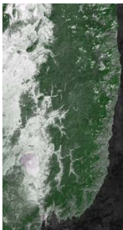
Зимний композит PROBA-V для территории Приморского края; псевдоцвета: R: 0,655 мкм, G: 0,837 мкм, B: 0,655 мкм
