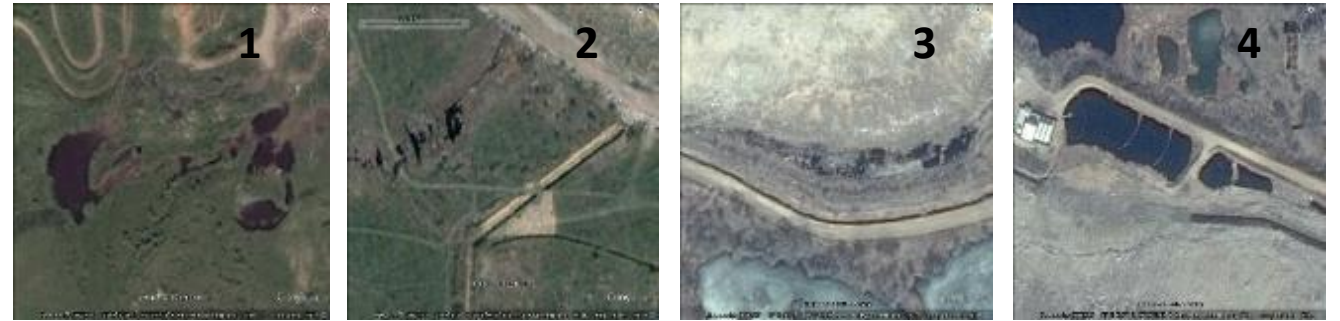
Формообразования филтраты: 1 – водоёмы, 2 – ручьи и каналы, 3 – канавы и рывины, 3 – водосборники (полигоны ТКО Кучино и Тимохово)
