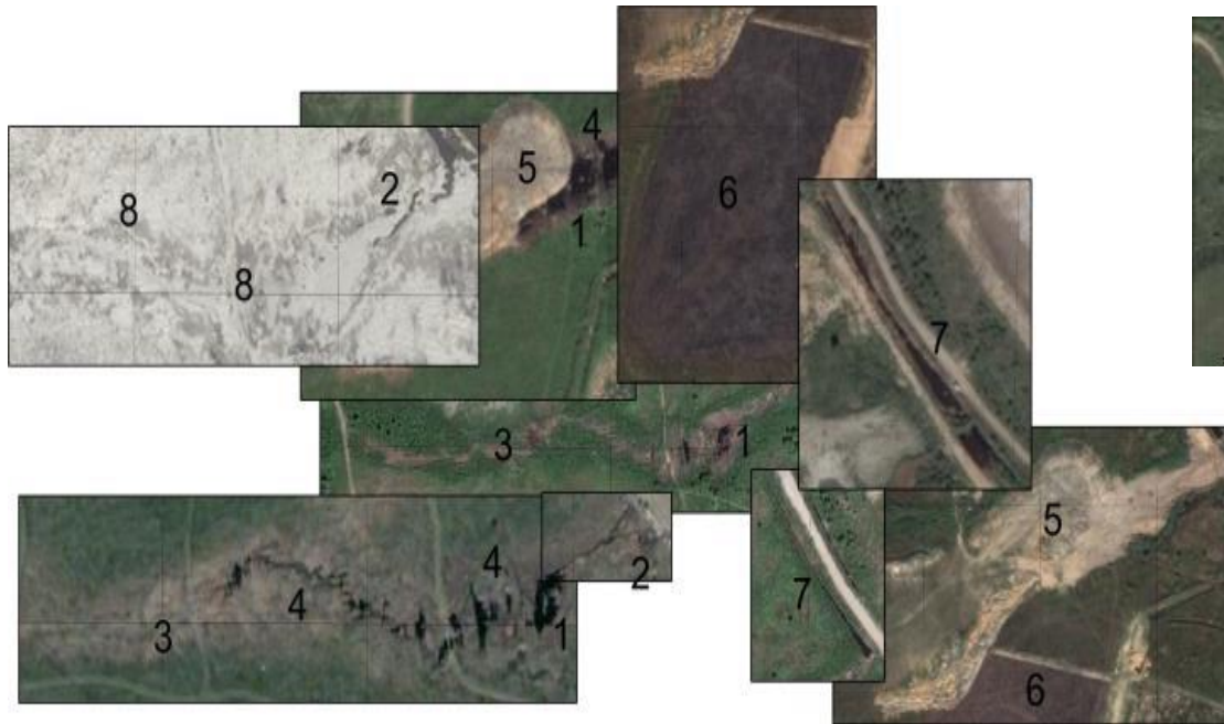
Компоненты фильтрационных процессов: 1 и 2 – фильтрационные водоёмы и ручьи, 3 – следы течения, 4 – берега, 5 – насыпь грунта, 6 – накопление филтраты в почве, 7 – сточные канавы, 8 – следы фильтрационных процессов (полигон ТКО Кучино)
