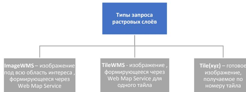
В стандартном картографическом интерфейсе, построенном по технологии GEOSMIS, используется только один тип слоя – ImageWMS, в переходе от которого к тайловой схеме и состояла задача. При этом тип слоя Tile(xyz) является самым легковесным и легко кешируемым в браузере.
