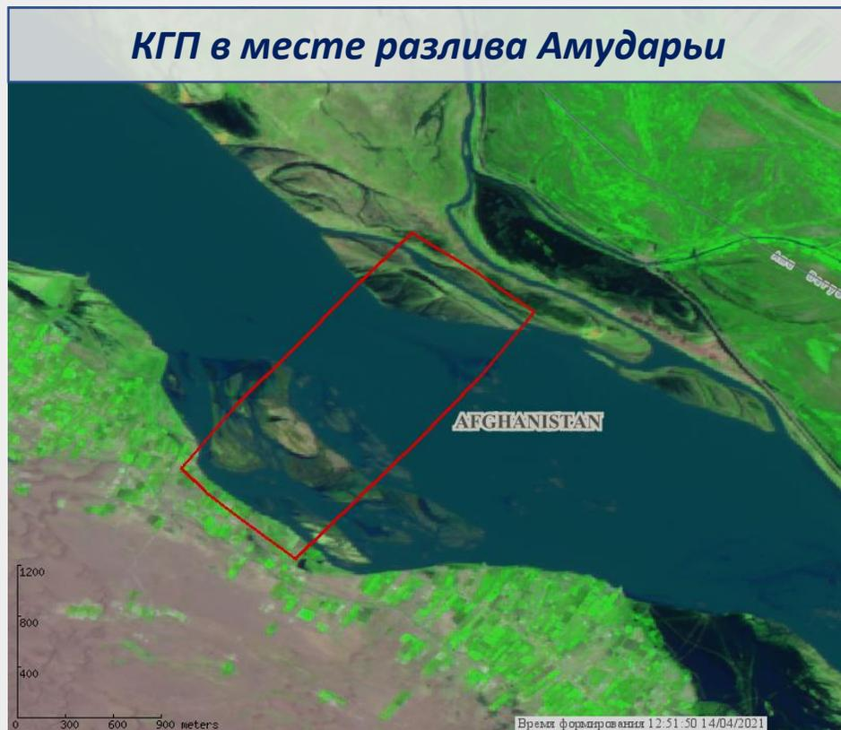
«Космический» гидропост (КГП) - произвольный полигон в базе данных с временными границами для поиска спутниковых сцен в архиве.
