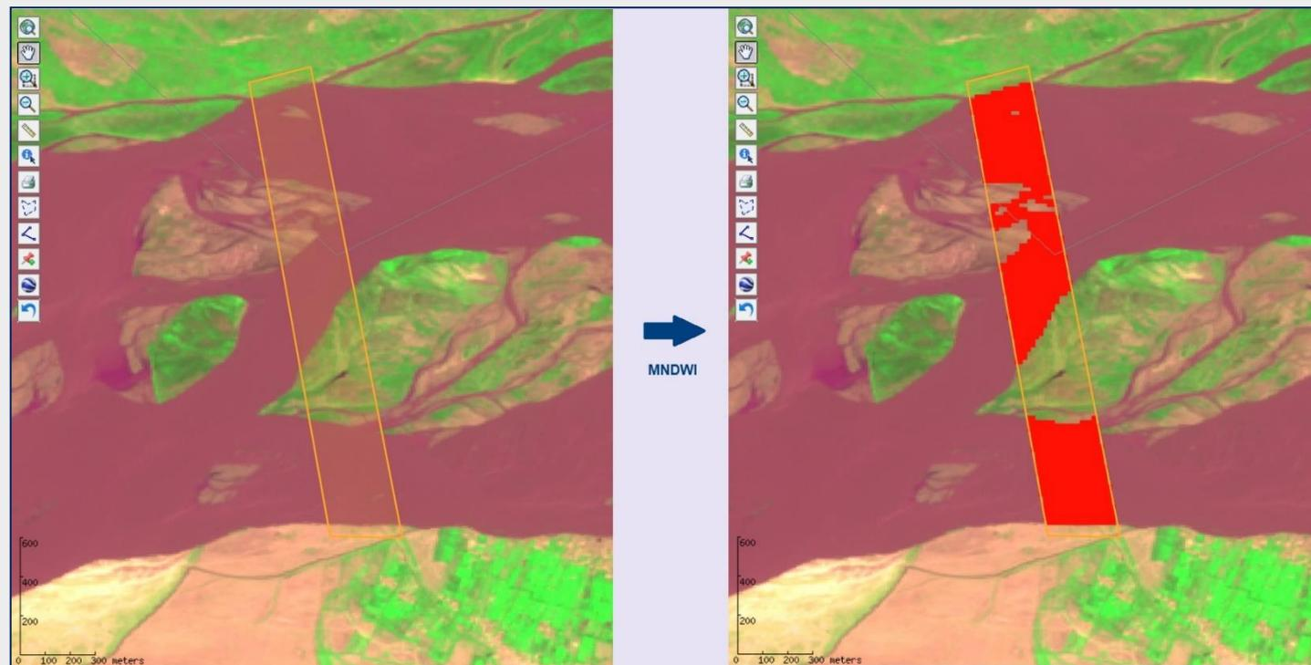
Оперативный расчет площади водного зеркала производится путем вычисления индекса MNDWI. Анализ множества спутниковых сцен из долговременных архивов для заданного периода занимает **несколько минут**
