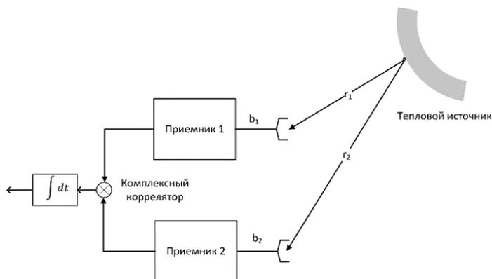
Тепловое излучение источника принимается антеннами, поступает на комплексный коррелятор (перемножитель) и, далее, на интегратор
