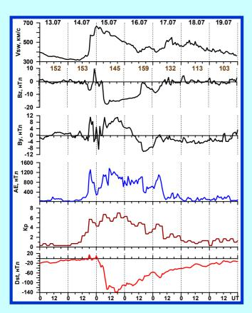
Рис.1. Сверху вниз показаны вариации Vsw, Bz и By компонент ММП, индексов AE, Kp и Dst. Числа под верхним графиком соответствуют значениям потока солнечного радиоизлучения F10.7.
