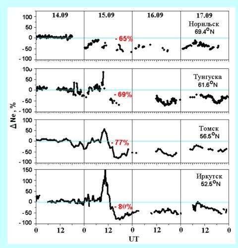
Показанные на рисунке нормированные отклонения максимальной электронной концентрации в процентах (определена как Ne=1.24·10<sup>4</sup>·foF2<sup>2</sup>) от фоновых значений, характеризующие глубину отрицательного ионосферного возмущения, имеют тенденции увеличения в вечерние часы и при переходе от субавроральных к средним широтам. Это указывает на значительный вклад экваториального смещения ГИП в формирование среднеширотного отрицательного ионосферного возмущения.
