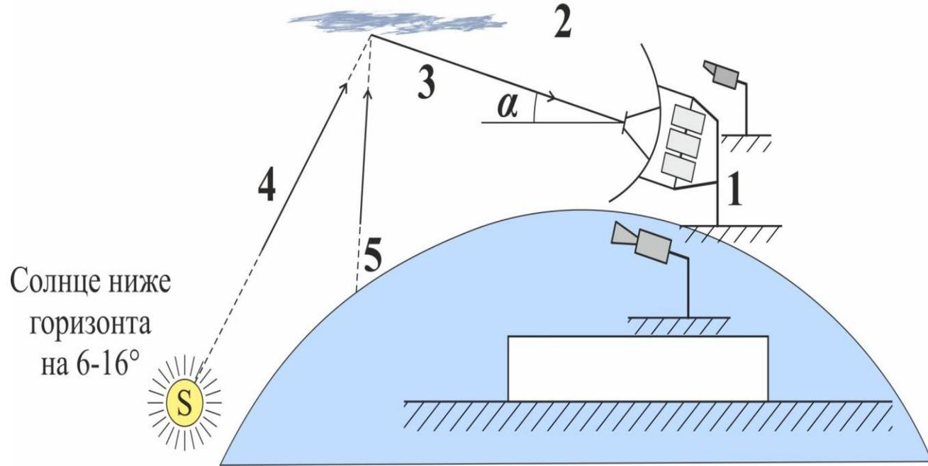
1- Микроволновые радиометры, 2 – мезосферные (серебристые) облака, 4,5 – тепловое излучение Солнца и поверхности Земли. Метод наблюдения предложен в (Bordonskiy et al., 2019). Установка смонтирована в с. Преображенка (Забайкальский край).
