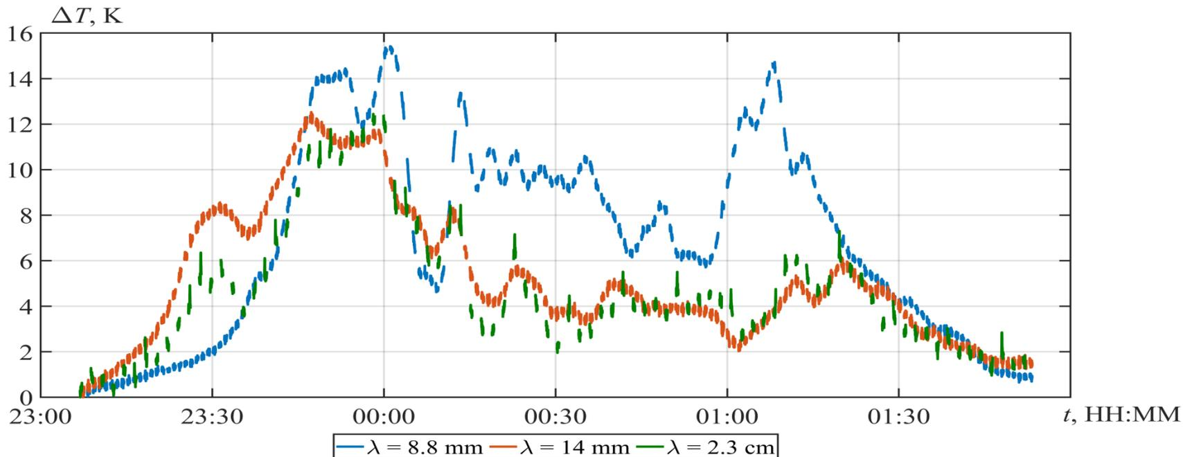
Зависимости приращений радиояркой температуры на трех длинах волн (8,8 мм, 14 мм и 2,3 см), возможно вызванных отражением излучения Солнца от серебристых облаков, состоящих из частиц с слоем высокой электропроводности на контакте лед 0 - диэлектрик.
