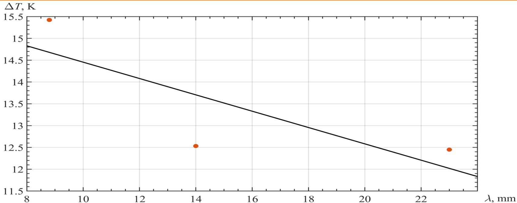
Зависимость максимумов приращений радиояркостной температуры на трех длинах волн (8,8 мм, 14 мм и 2,3 см), вызванных отражением излучения Солнца от серебристых облаков от длины волны в мм.
