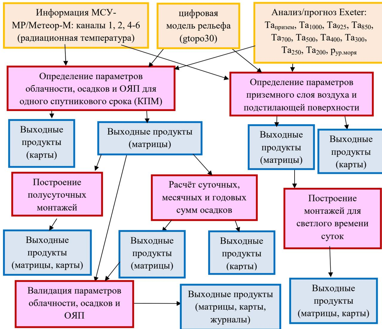
*Рис. 1. Технологическая схема работы АПК «MSUMRexeter»*
