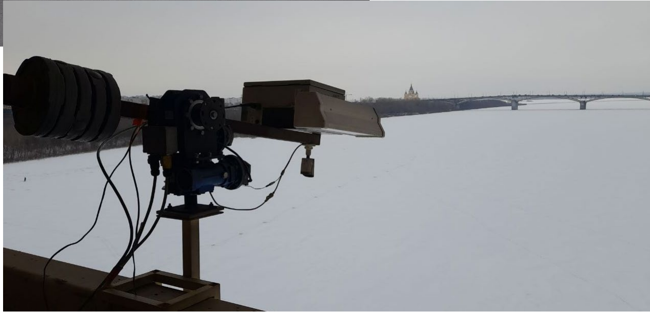
Рисунок 1. Фотография поверхности реки с камеры установленной на «Река X» (сверху) и фотография радиолокатора «Река X» во время зимней серии экспериментов (снизу).
