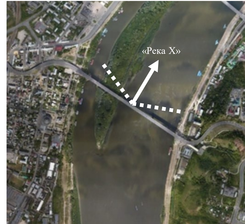
Рисунок 2. Схема установки. Белой стрелкой указан перпендикуляр к мосту. Пунктирные линии показывают конструктивные ограничения – предельные азимутальные углы поворота радиолокаторов «Река X» - 190^{\circ} - 350^{\circ} .
