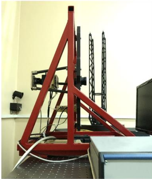
Стенд для отработки режимов съемки с компенсацией смаза
