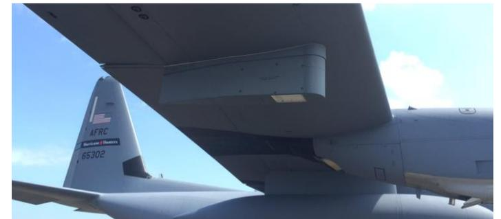
Радиометр под крылом самолета
