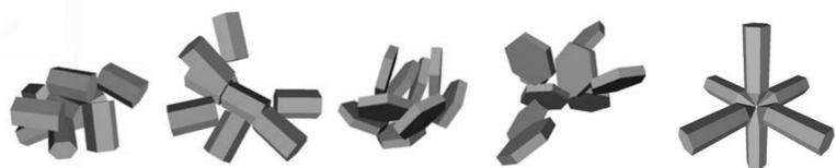
Рисунок 2 – Геометрические модели агрегата состоящего из столбиков и пластинок (расположенных как компактно, так и разрежено), и агрегата типа «bullet-rosette».
