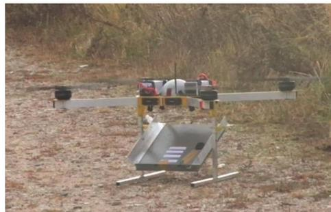
Внешний вид СВЧ-радиометра, размещенного на квадрокоптере
