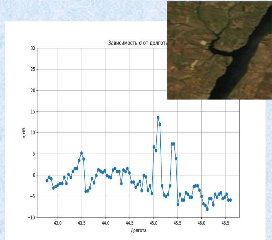
Радарное изображение и разрез для угла падения 4° (02.04.2022)
