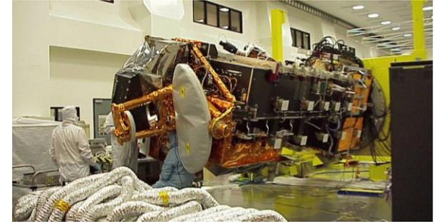
Инструмент SABER (Sounding of the Atmosphere using Broadband Emission Radiometry) является одним из четырех инструментов на спутнике NASA TIMED (Thermosphere Ionosphere Mesosphere Energetics Dynamics) для получения вертикального профиля температуры в области MLT (мезосфера и нижняя термосфера). Температура SABER TIMED извлекается из измерения каналов CO<sub>2</sub>.
