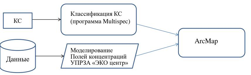
Блок – схема алгоритма оценки риска воздействия горизонтальных факельных установок
