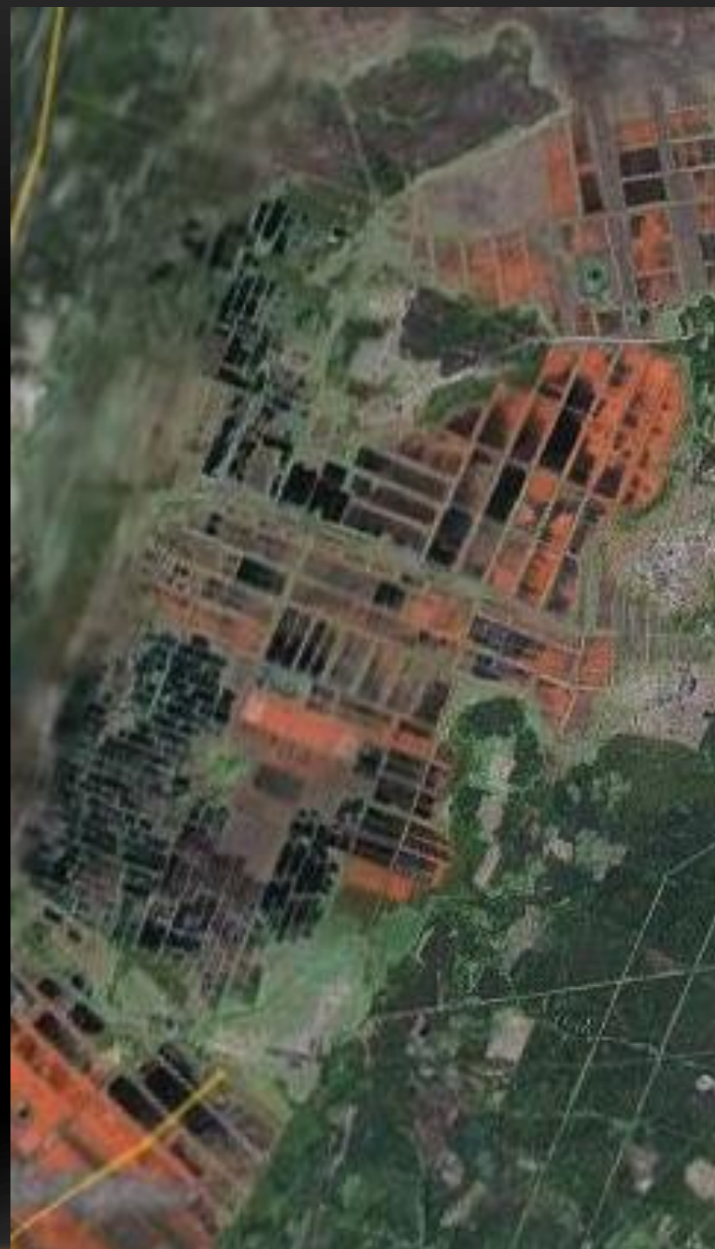
Брошенные частично выработанные поля фрезерной добычи торфа
