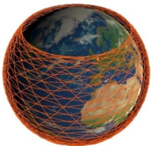
Рис. 6. Орбиты 1-й группы КА на высоте 550 км с наклоном 53° в составе 1-й фазы ОГ CCC Starlink
