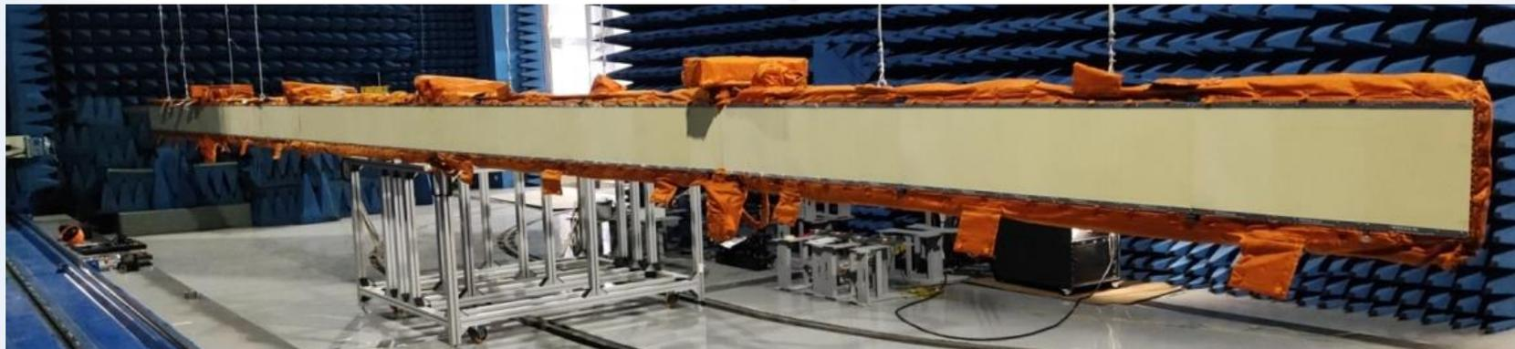
Рис. 2. Стенд наземной настройки АФАР БРЛК КА «Метеор-М»
