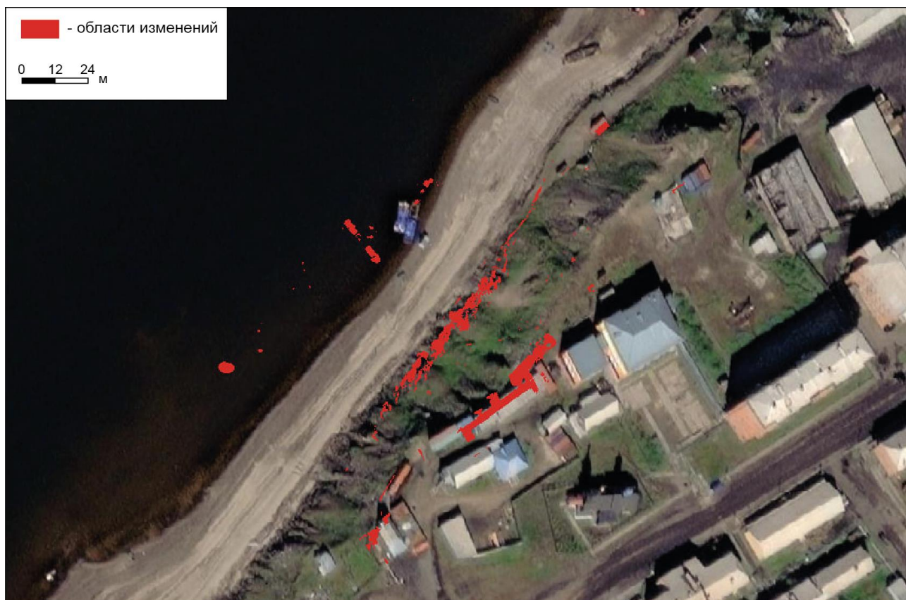
Рис. 2. Соотношение ортофотопланов береговой линии с.п. Хатанга в 2023 и 2024 гг.
