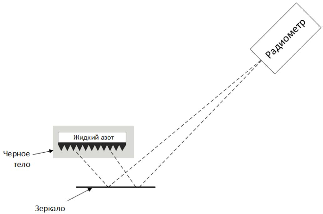
Калибровка производится по излучению черного тела при комнатной температуре и при охлаждении жидким азотом.
