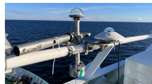
Пиранометры: M115-M (слева), K&Z CMP 11 (справа), установленные на пеленгаторной палубе НИС “Профессор Молчанов”
