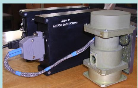
Сканирующая система содержит узел контроля положения зеркала на датчиках Холла Рабочая зона визирования — 15град Точность положения — 0,7 град Количество шагов — 22. Время изменения шага — не более 1сек. Период изменения шага — 4 сек.
