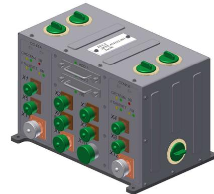
Формирует команды управления и выдает их в ССОД спектрометра высокого разрешения, а также обеспечивает прием и накопление служебных и научных данных, получаемых от СВР, с последующей их передачей в служебные системы РС МКС для передачи на Землю
